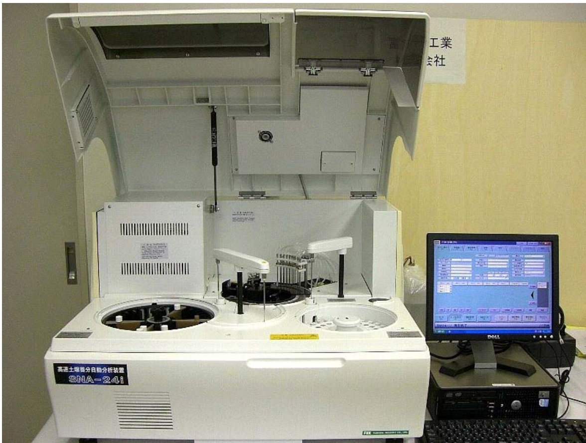
写真1 自動化学分析装置(高速土壤養分自動分析装置 SNA-24i)
