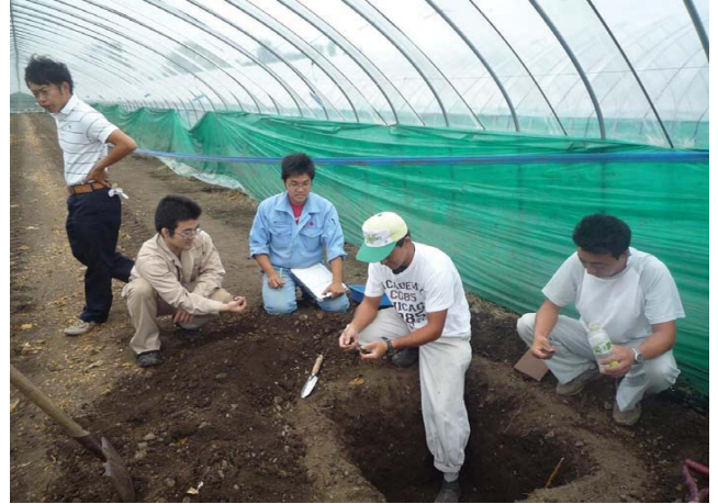
写真2 土壤断面調査 土壤構造、土性、粘性の測定
