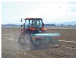
ライムソーによる転炉スラグの散布
